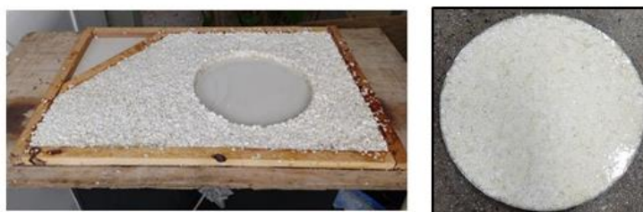
Figura 3. Bancada de pia e tampo de banco fabricados com o material compósito proposto.
