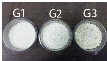
Figura 2. Diferentes granulometrias do resíduo de casca de ovo: G1, G2 e G3.
