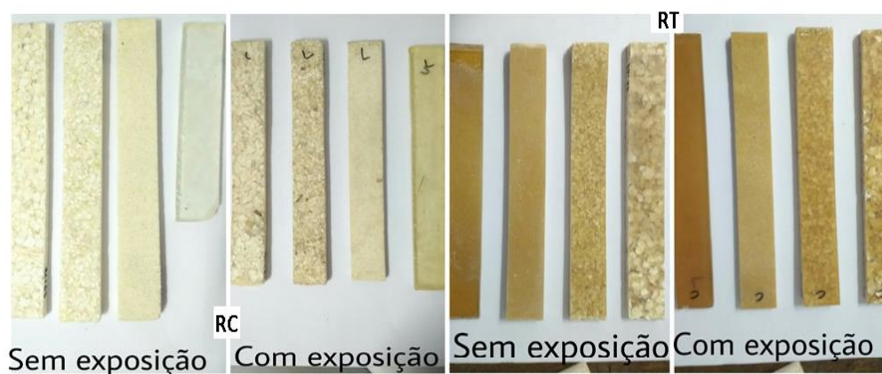
Figura 4. Amostras das formulações do compósito e das resinas testadas no ensaio de envelhecimento.
