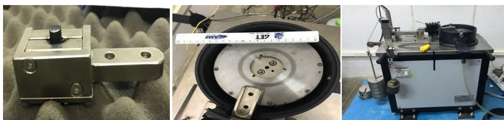
Figura 3. Aparato experimental para o ensaio Pino-Disco.
