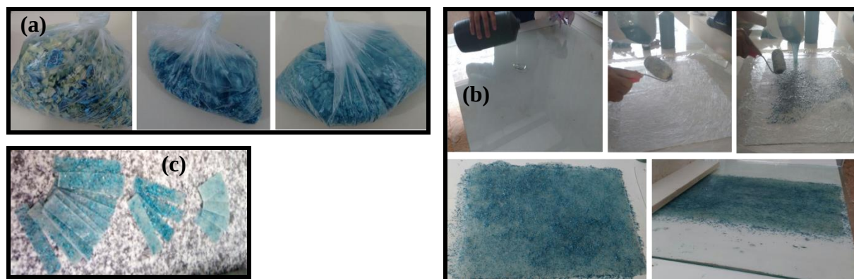
Figura 01 – (a) Resíduos da indústria e seleção (b) Processo de fabricação (c) Corpos de prova.
