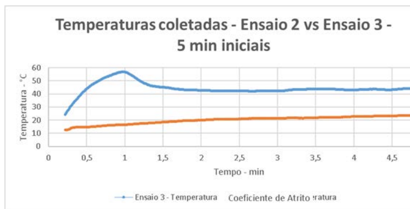
Figura 11 - Temperaturas coletadas durante o ensaio de pino sobre disco.
