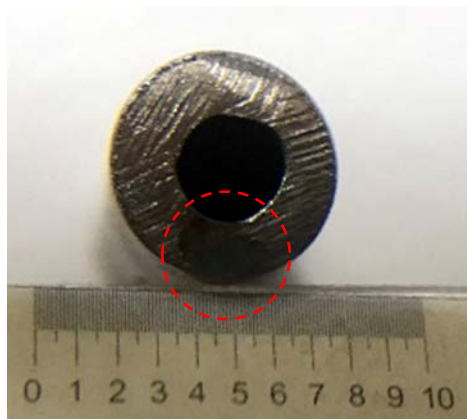
Figura 7 – Área de contato do pino: região lisa na parte inferior da imagem, se limitou a aproximadamente 3,00 mm 2 . As ranhuras mais persentes são provenientes do processo anterior de preparação do material (Escala em mm).
