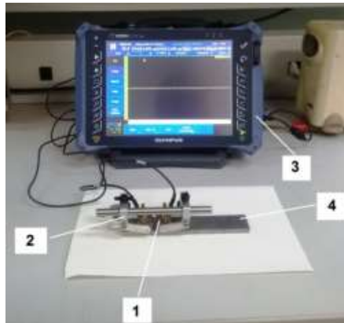
Figura 4: Sistema de medição por TOFD: (1) Transdutores de 10 MHz; (2) Sapata (3) Equipamento Omniscan MX2 (4) Amostra analisada.
