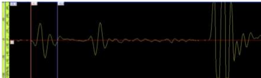
Figura 5. A-Scan típico do sinal para o pós processamento da onda lateral (pelo Tomoview).
