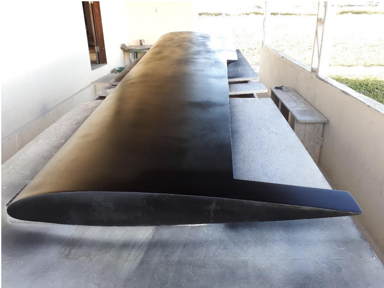
Figura 13. Perfil NACA 23012 com um metro de corda.
