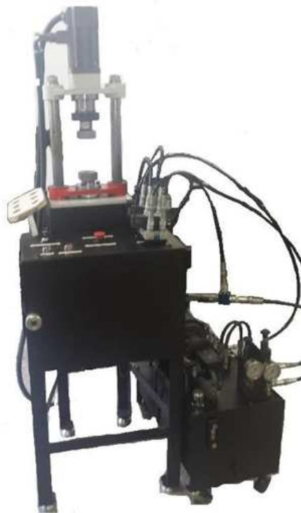
Figura 1. Máquina didática por solda por fricção convencional.
