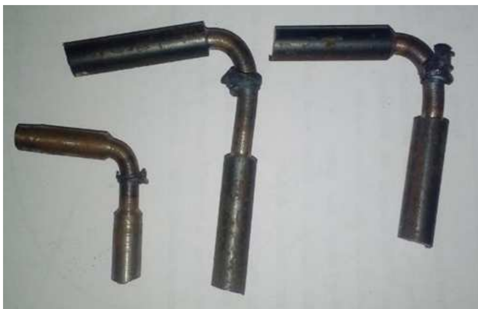
Figura 6. Corpo de prova do ensaio de soldagem por fricção após o ensaio de arrancamento.
