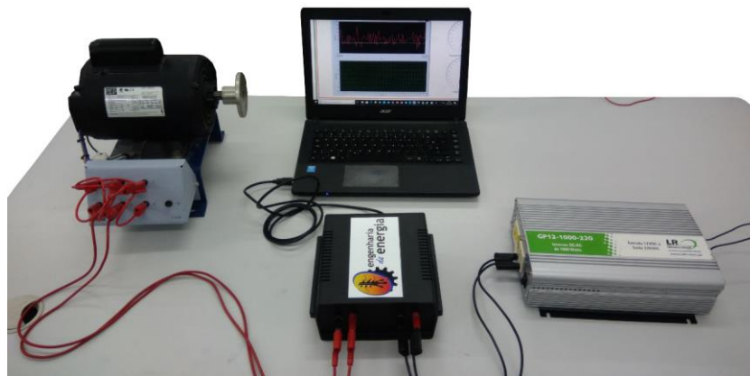
Figura 5: Sistema de medição conectado a uma carga indutiva e alimentado pelo inversor de tensão ligado ao gerador eólico (Laboratório de Pesquisa em Energia Elétrica – IFRN)
