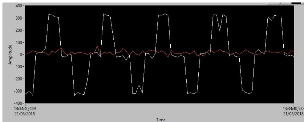
Figura 7: Tensão (branco) e corrente (vermelho) apresentados pelo software para o sistema conectado ao inversor de tensão alimentado pelo gerador eólico.
