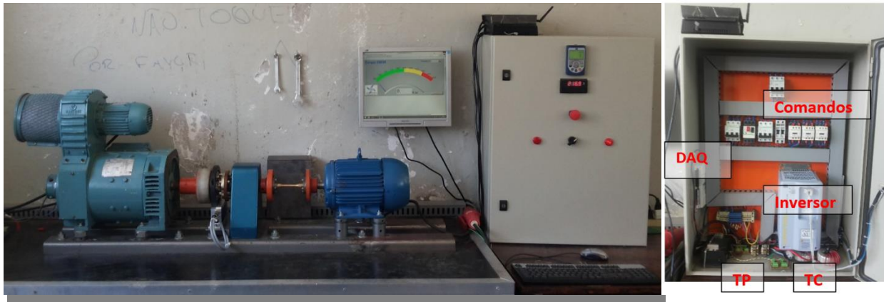
Figura 2. Bancada desenvolvida para ensaio de medição de torque em plena rotação (GPICEEMA-UFPB)
