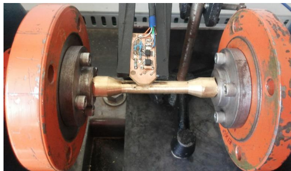
Figura 4. Sistema pronto para medição em plena rotação
