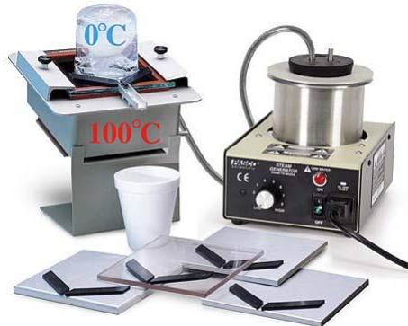
Figura 6. (Fonte: PASCO – MODELO: TD-8561) – Aparelho de condutividade térmica.
