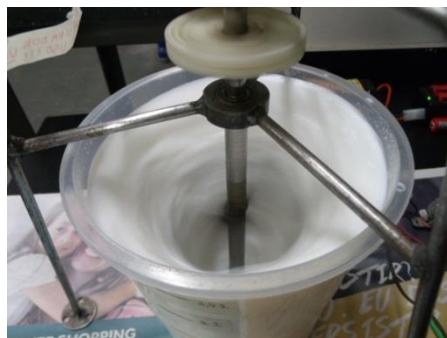
Figura 4. Utilização do misturador para preparação do fluido emulsionável 10%
