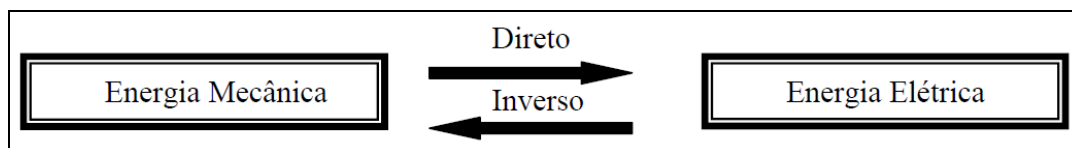
Figura 1. Representação esquemática da conversão de energia no efeito piezoelétrico.
