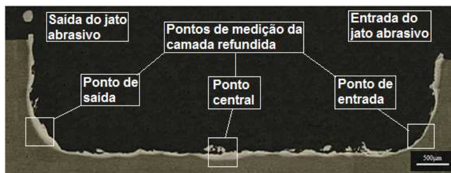
Figura 4 – Posições medidas na cavidade erodida.
