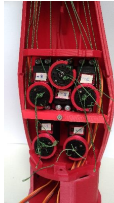
Figura 5. Base do antebraço com servo motores e fios montados, elaboração própria.
