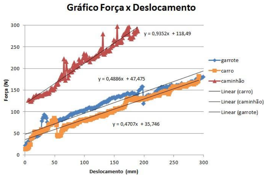
Figura 5 - Gráfico comparativo das curvas características dos materiais (força x deslocamento)
