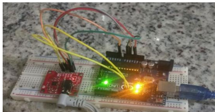
Figura 8. Circuito montado e captando o sinal cardíaco
