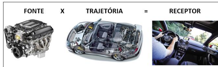
Figura 1. Esquema do processo de percepção do ruído em veículos.
