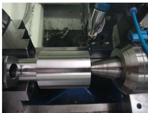
Figura 3. Corpo de prova de aço SAE 4340 utilizado no ensaio de potência elétrica ativa.
