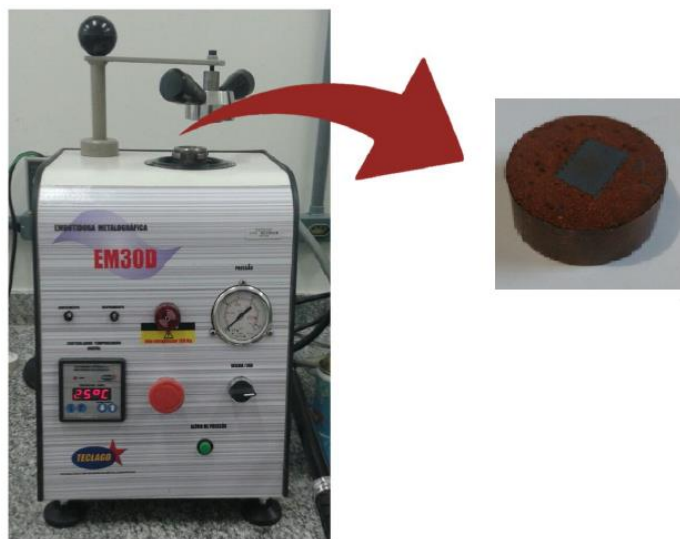
Figura 4. Embutidora metalográfica com corpo de prova (Fonte: Autoria Própria)
