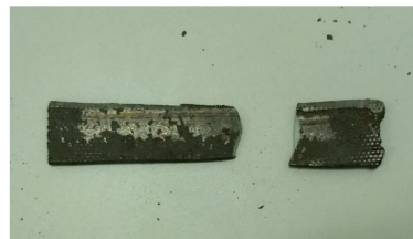
Figura 4: Corpo de prova após ensaio de tração até a ruptura (CP 1) 31,2 KN
