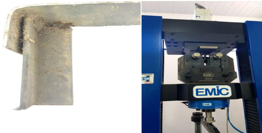
Figura 2: Junta soldada antes do ensaio à esquerda e máquina realizando ensaio de tração à direita
