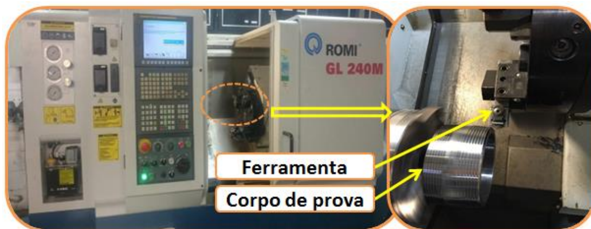
Figura 1. Centro de torneamento ROMI e usinagem do corpo de prova (Autoria própria).
