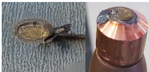
Figura 2. Ponto de solda e eletrodo afetados por respingos.
