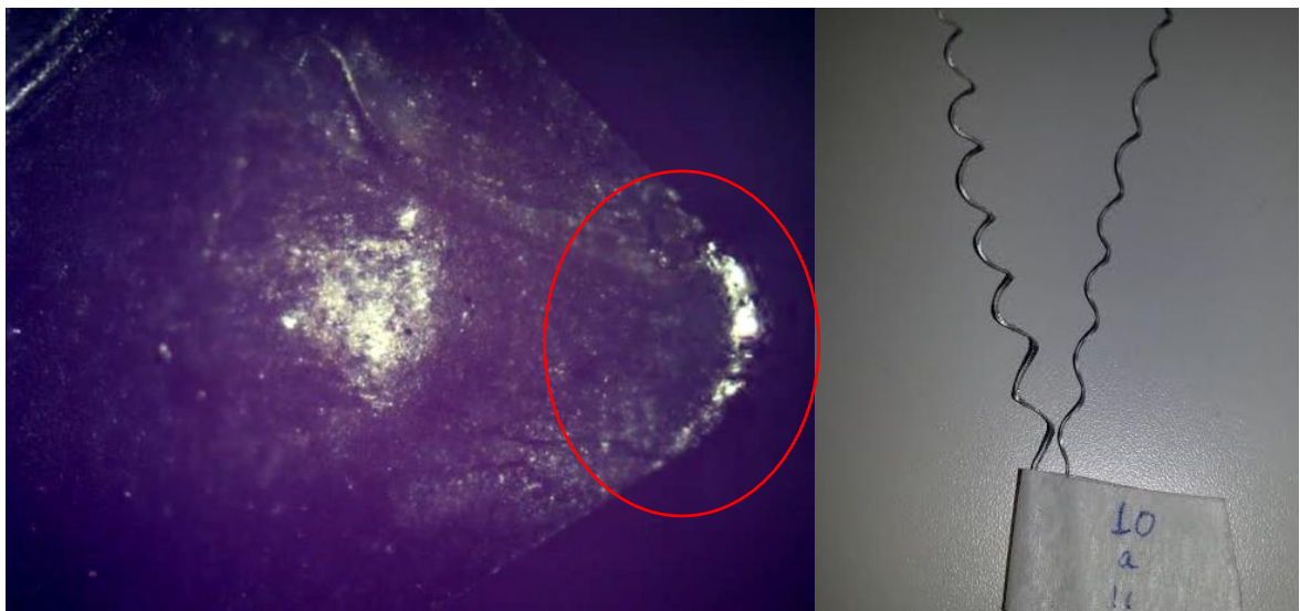
FIGURA 7: Superfície da pastilha de metal duro ampliada 50 vezes.
