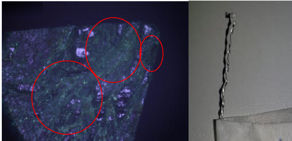
FIGURA 4: (a) superfície da ferramenta de aço rápido com ângulo de saída de 0^\circ , ampliação de 50 vezes (b) cavaco gerado pelo mesmo.
