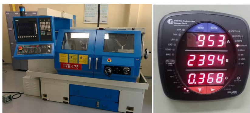
Figura 2. (a) Torno CNC Veker modelo LVK-175 com módulo Siemens 808D. (b) medidor de potência
