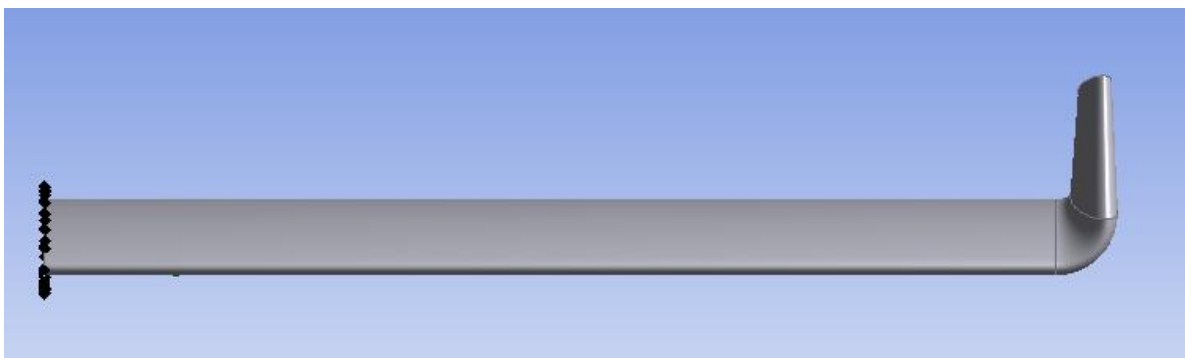
Figura 9. Semi-envergadura da asa com ponta com winglet .
