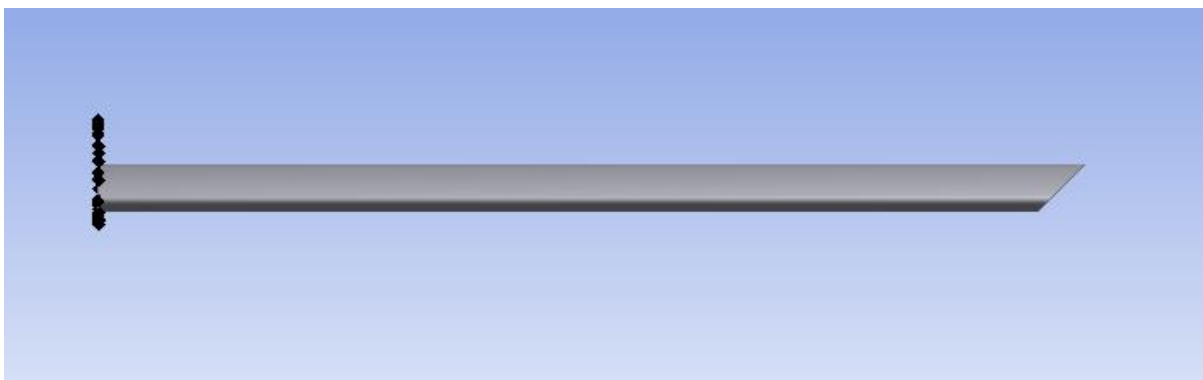
Figura 7. Semi-envergadura da asa com ponta chanfrada.
