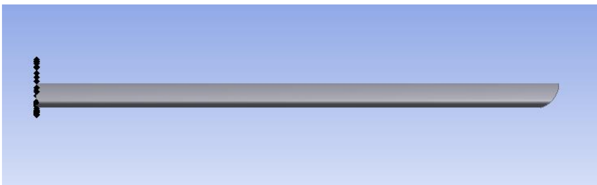
Figura 8. Semi-envergadura da asa com ponta com filete.
