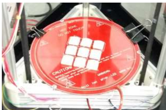
Figura 3: Mesa aquecida utilizada na Impressora Kossel Delta 3D
