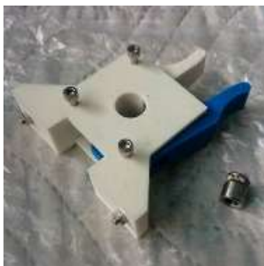
Figura 1: Extrusora utilizada na Impressora Kossel Delta 3D
