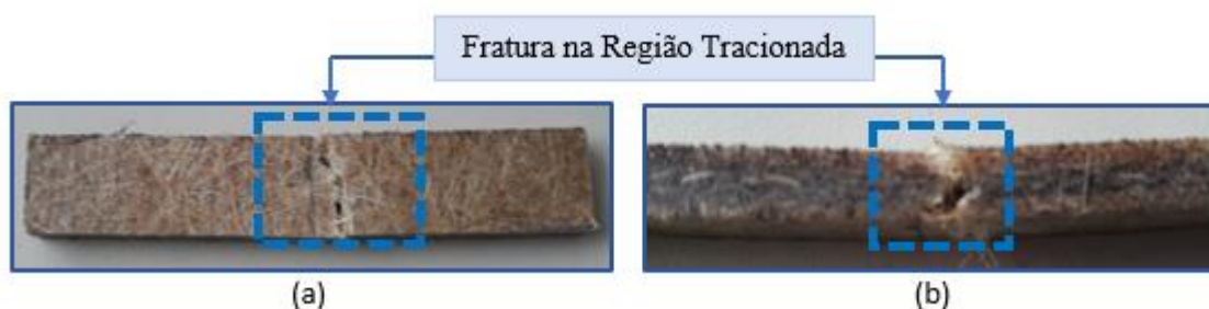
Figura 4. Fratura final nos CP's Sisal/Canabrava – Flexão em Três Pontos. (a) Superfície tracionada do CP; (b) Superfície transversal do CP.
