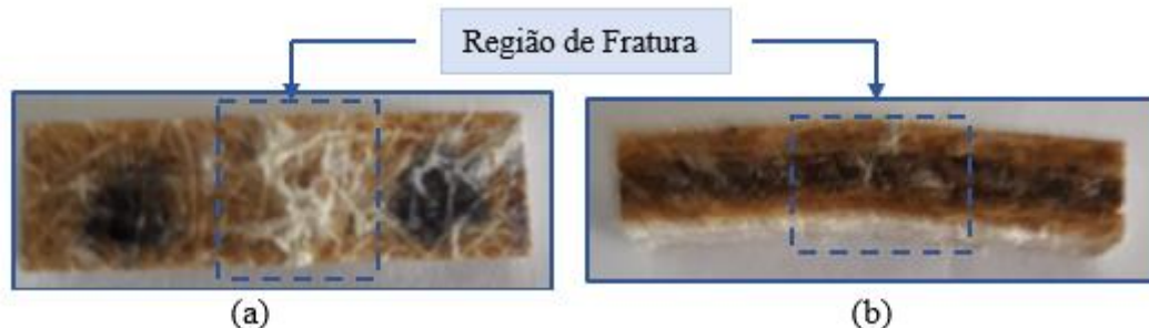
Figura 8. Fratura final nos CP's Sisal/Canabrava – Cisalhamento Interlaminar ( Short beam ). (a) Superfície tracionada do CP; (b) Superfície transversal do CP.
