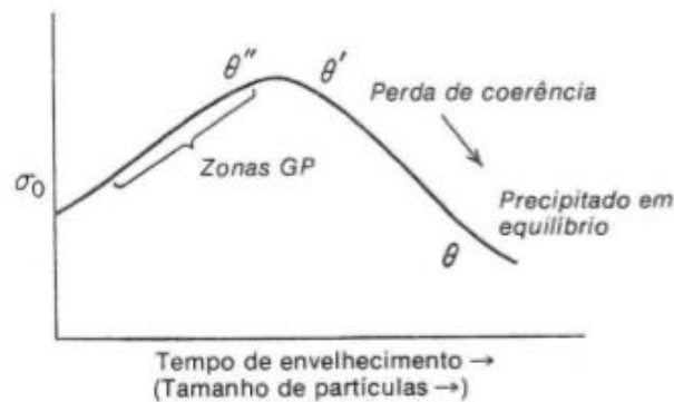
Figura 1. Variação da tensão de escoamento com o tempo de envelhecimento (Dieter, 1961).
