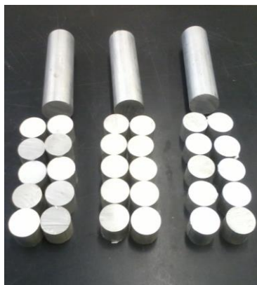
Figura 1: Barras de alumínio usadas nos experimentos e seccionadas nas dimensões apropriadas.
