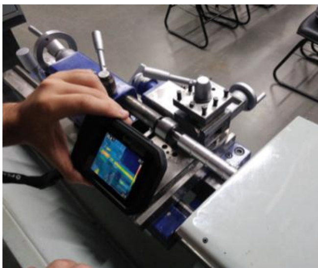
Figura 3. Medição da temperatura com a câmera FLIR C2 a seco.
