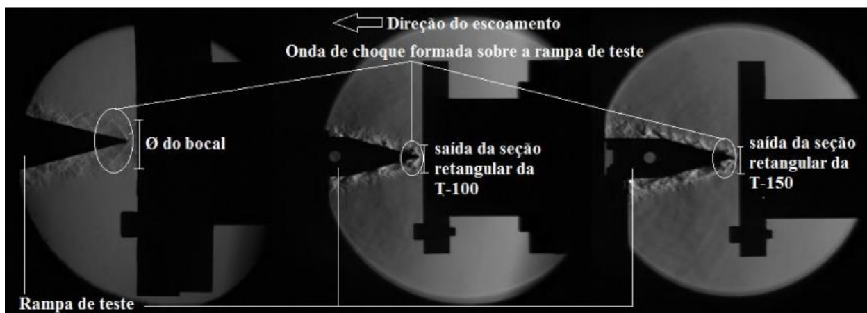
Figura 15. Exemplo das imagens schlieren utilizadas para determinação do número de Mach no bocal e nas peças de transição T-100 e T-150.
