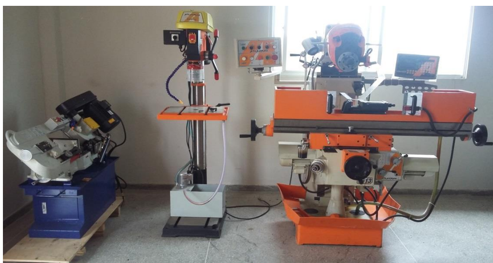
Figura 2: Distância evidenciada entre a serra fita horizontal, furadeira de coluna e fresadora ferramenta.
