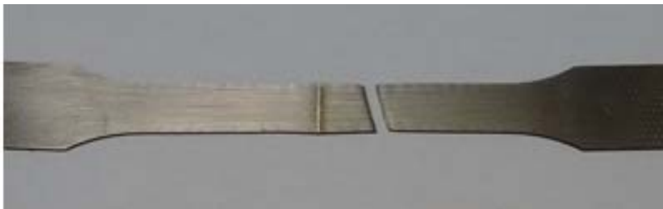
Figura 5. Corpo de prova de tração rompido no metal base. Amostra CP80.
