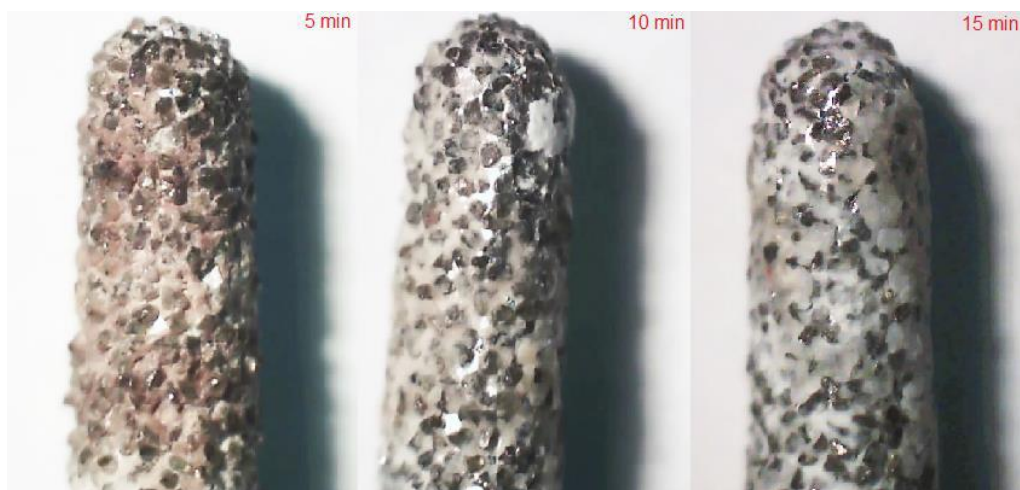
Figura 7. Brocas diamantadas sem revestimento após o experimento.
