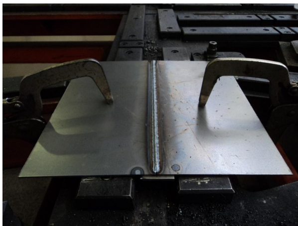
Figura 1. Posicionamento das placas metálicas para soldagem.
