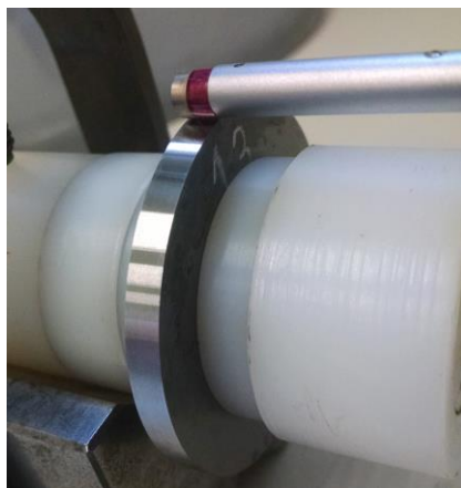
Figura 4: Rugosidade Média sendo aferida em um corpo de prova.
