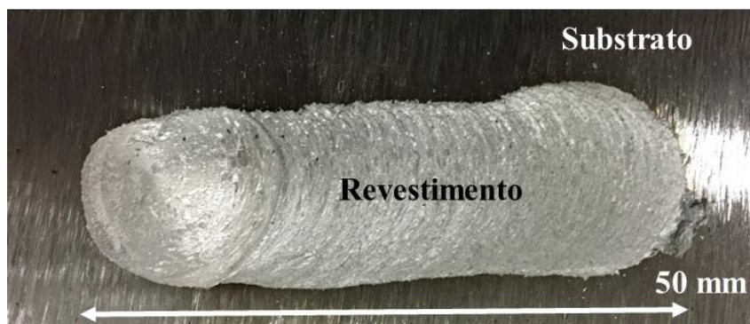
Figura 2 – Vista superior do revestimento antes do tratamento térmico.
