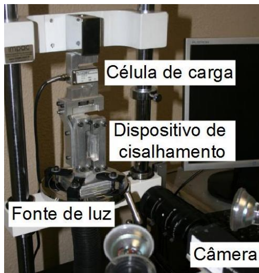
Figura 2. Arranjo experimental para ensaio de cisalhamento simples.
