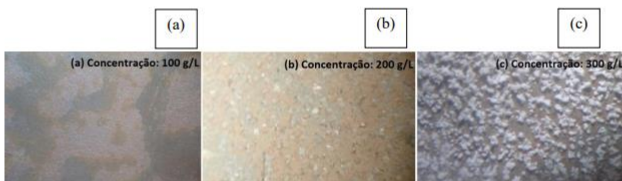
Figura 2. Microestrutura do aço 1020 submetida ao processo de corrosão sob ação de cloreto de NaCl nas concentrações: (a) 100 g/L; (b) 200 g/L; (c) 300 g/L.
