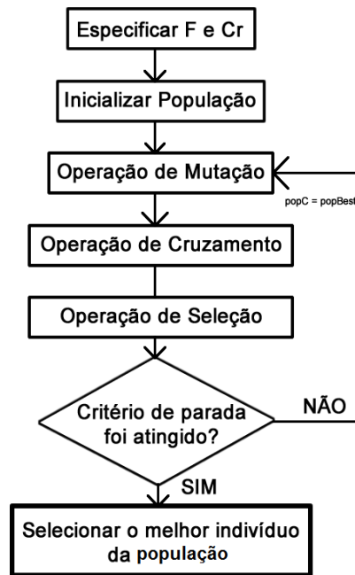
Figura 3. Fluxograma resumido do Método Evolução Diferencial
