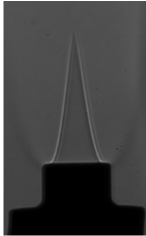
Figura 5. Imagem usando a técnica do “schlieren” para a chama do gás pobre.
