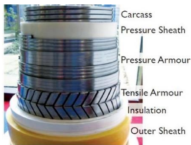
Figura 6: Riser com suas diversas camadas.
