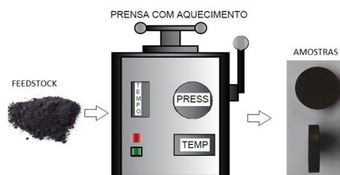
Figura 2 - Esquema da compactação das amostras.
