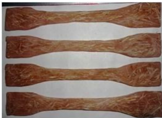
Figura 3. Compósitos preparados para os ensaios de tração.
