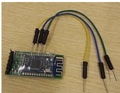
Fig. 5 - Módulo Bluetooth BLE 4.0 após atualizar o programa base.
