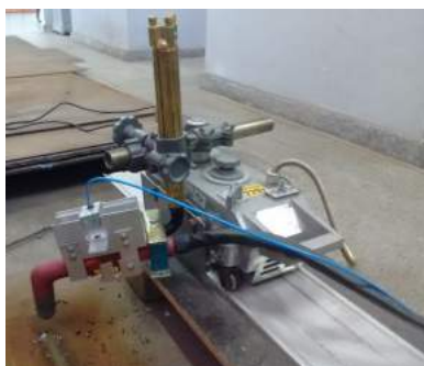
Figura 4: Carro sobre trilhos da máquina de corte MC-46 utilizada para a execução da trajetória.
