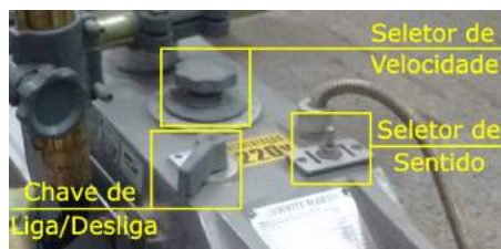
Figura 6: Seletores de velocidade e sentido (FONTE: Próprio autor).
