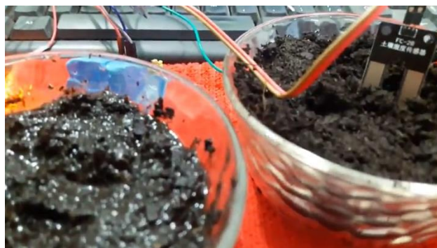
Figura 8 – Montagem e teste do circuito 3, sensor de umidade (Autor)
