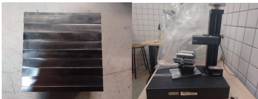
Figura 5. Verificação de rugosidade. (a) Canais em corpo de prova. (b) Rugosímetro
