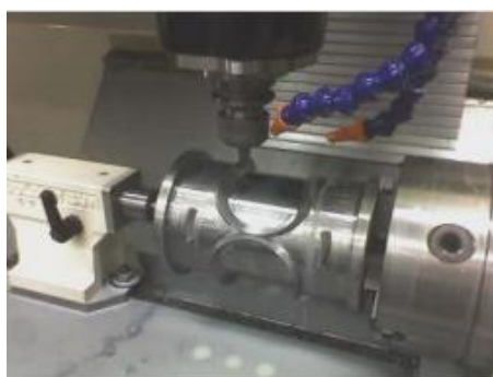
Figura 2. Processo de fresamento com utilização da técnica MQL.
