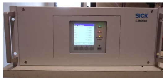
Figura 4: Analisador de gases utilizado para monitorar os principais poluentes atmosféricos.
