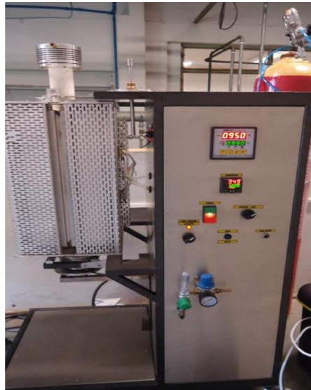
Figura 2: Forno tubular de queda livre (DTF) utilizado para a combustão das biomassas.
