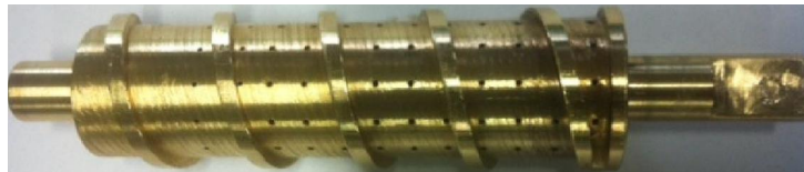
Figura 3: Parafuso-rosca com furos ao longo de toda a superfície – parte do sistema de alimentação e controle da velocidade rotacional.
