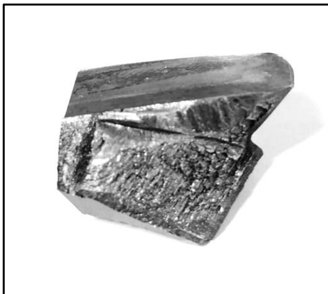
Figura 5. Fratura do dente da engrenagem analisada
